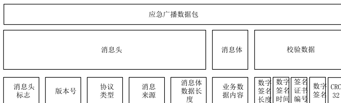
图A.1 应急广播平台与大喇叭前端适配器通讯数据包格式图
